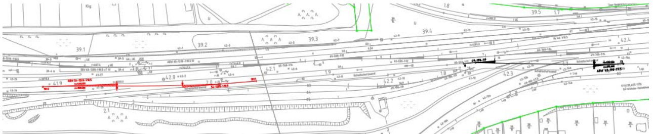
Abbildung 8 – Strecke 1720, zusätzliche Weichenverbindung km 41,9 – km 42,1
